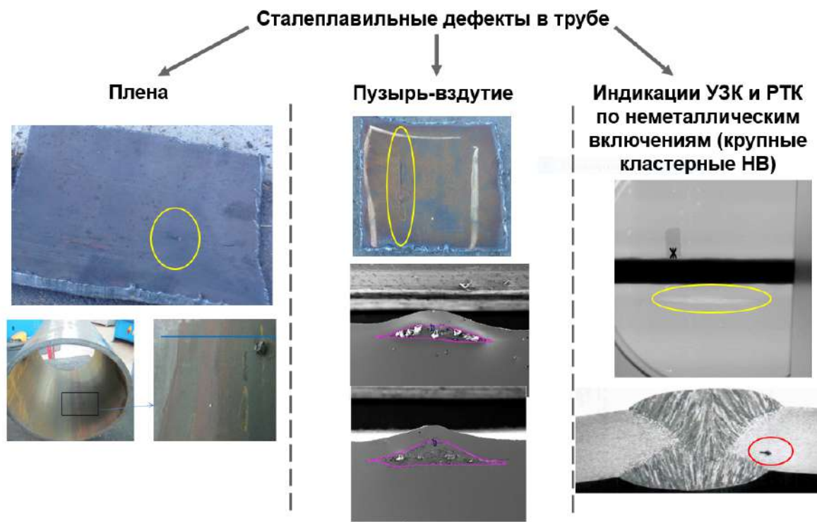
Рисунок 3.36 – Распространённые сталеплавильные дефекты в сварной трубе из-за неметаллических включений
