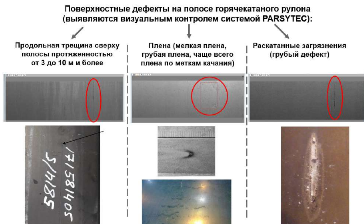
Рисунок 3.33 – Распространённые поверхностные сталеплавильные дефекты на металлопрокате ЛПК, связанные с неметаллическими включениями
