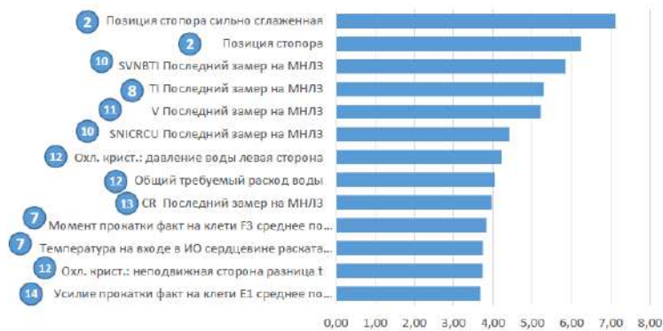
Рисунок 3.39 – Результаты применения алгоритмов машинного обучения к ~800 технологическим параметрам сталеплавильного производства, разливки стали на УНРС и горячего проката рулонов
