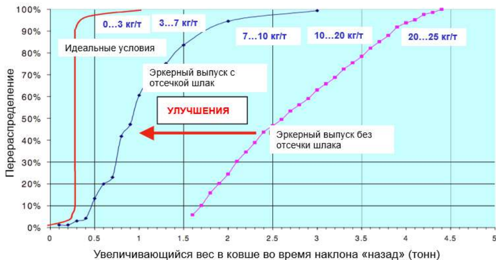
Рисунок 3.6 – Увеличение веса в сталеразливочном ковше во время наклона печи «назад» и количество попадающего печного шлака в кг на тонну стали [136]
