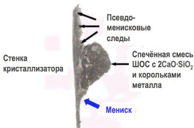
Рисунок 4.7 – Шлаковые корки и плёнки, формирующиеся в кристаллизаторе УНРС
