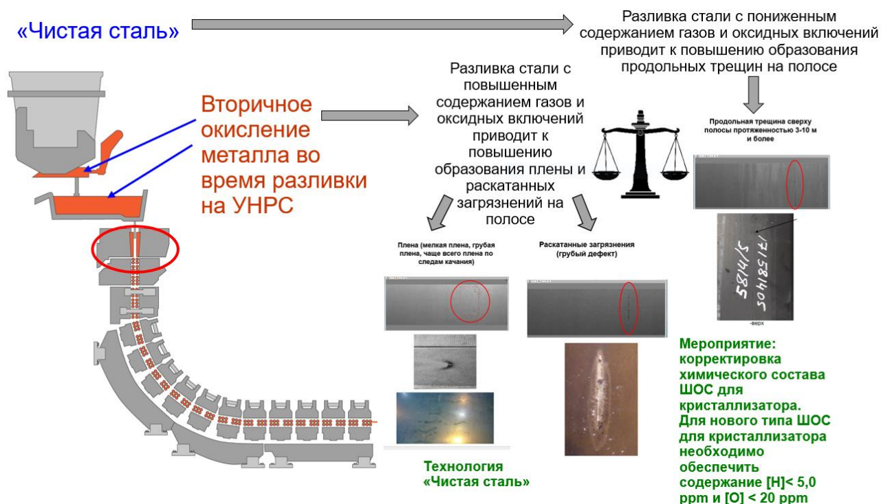
Рисунок 4.6 – Влияние чистоты стали на изменение свойства ШОС в кристаллизаторе и поверхностные дефекты на горячекатаной полосе
