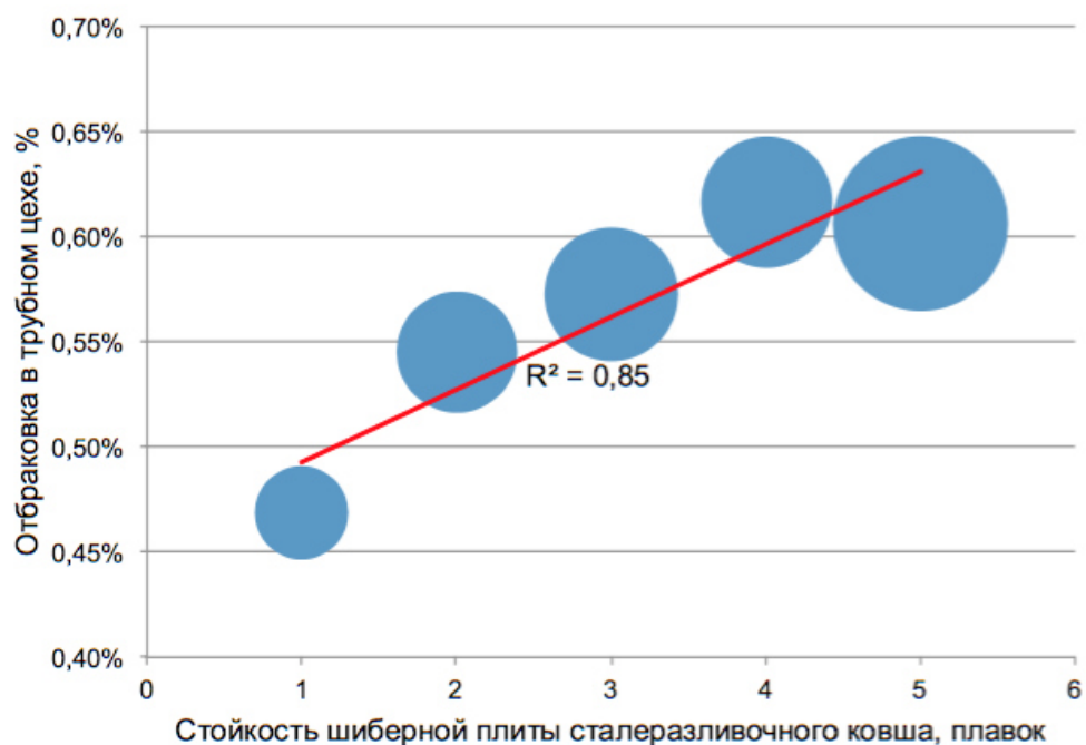
Рисунок 3.16 – Отбраковка по дефекту «пузырь-вздутие» в зависимости от стойкости шиберных плит сталеразливочного ковша
