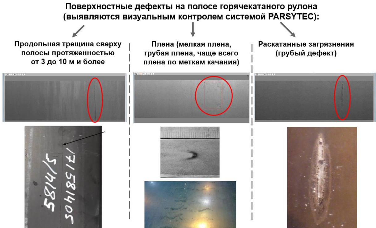
Рисунок 3.22 – Распространённые поверхностные сталеплавильные дефекты на металлопрокате ЛПК, связанные с неметаллическими включениями
