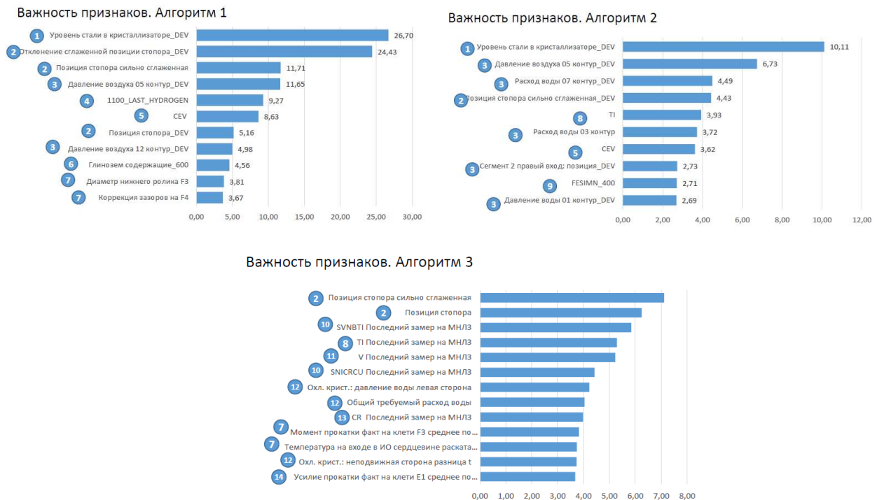
Рисунок 3.28 – Результаты применения алгоритмов машинного обучения к ~800 технологическим параметрам сталеплавильного производства, разливки стали на УНРС и горячего проката рулонов
