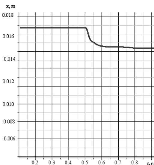
Рисунок 3.26. Перемещение золотникового клапана.
