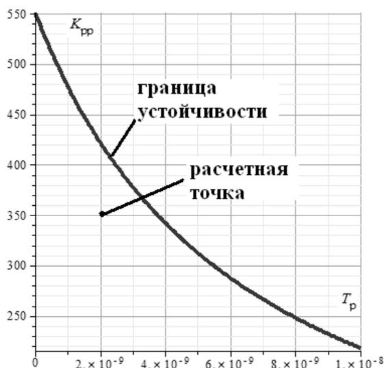
Рисунок 3.37. Область устойчивости параметров регулятора расхода
