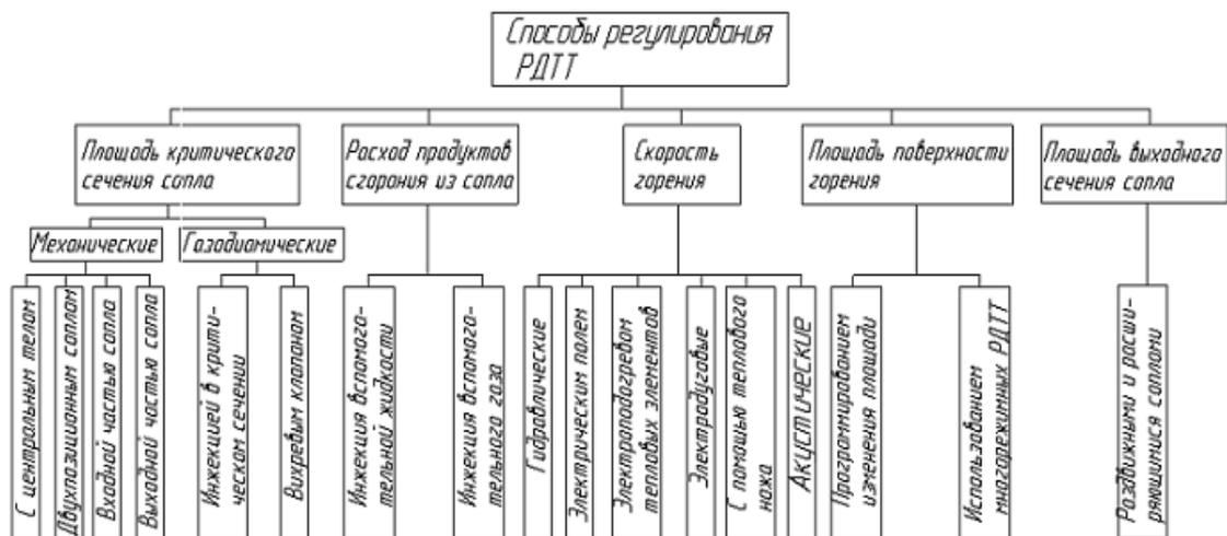
Рисунок 1.2. Способы регулирования РДТТ
