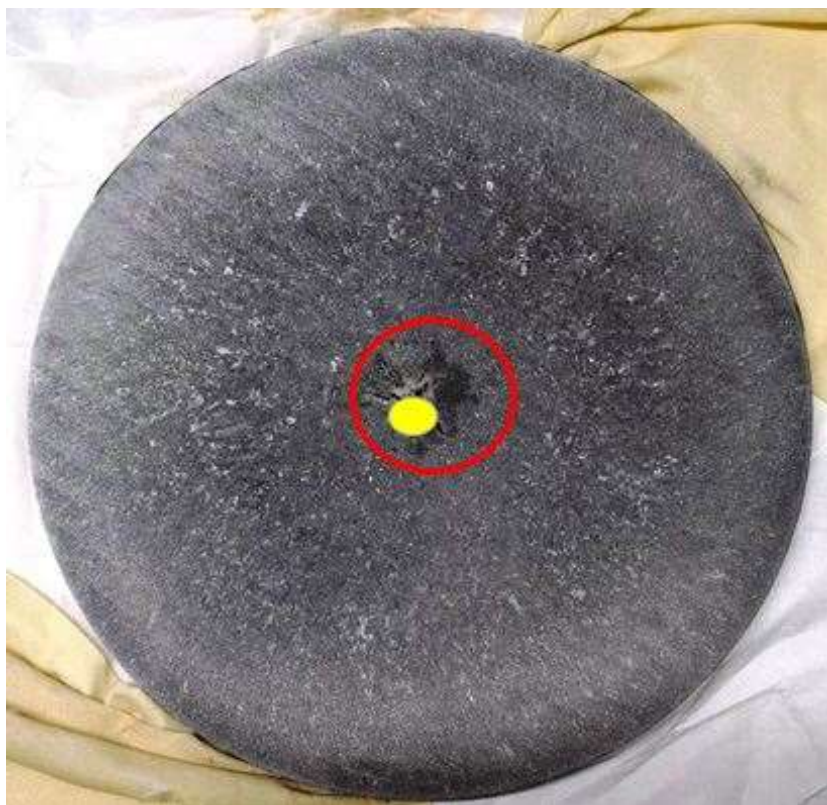
Рисунок 3 – Темплет заготовки из стали марки 15X13H2 диаметром 340 мм
