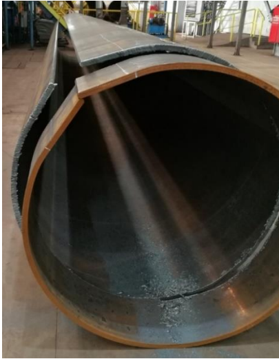
Рисунок 11 – Изменение диаметра кольца в результате отрезки от трубной заготовки
