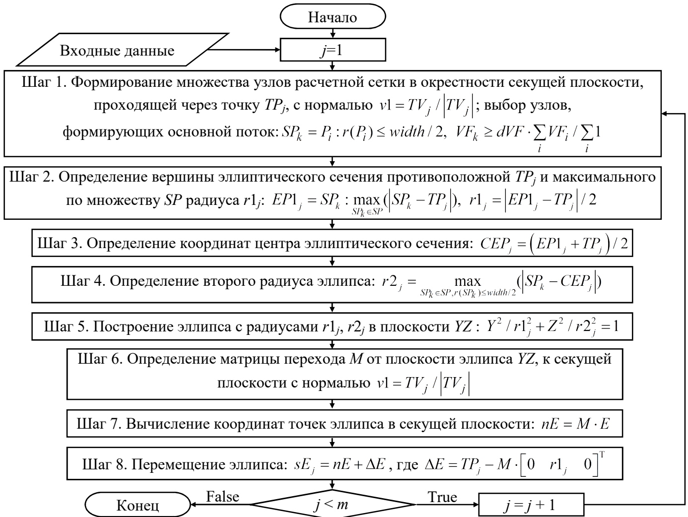
Рисунок 19 – Блок-схема алгоритма эллиптических сечений
