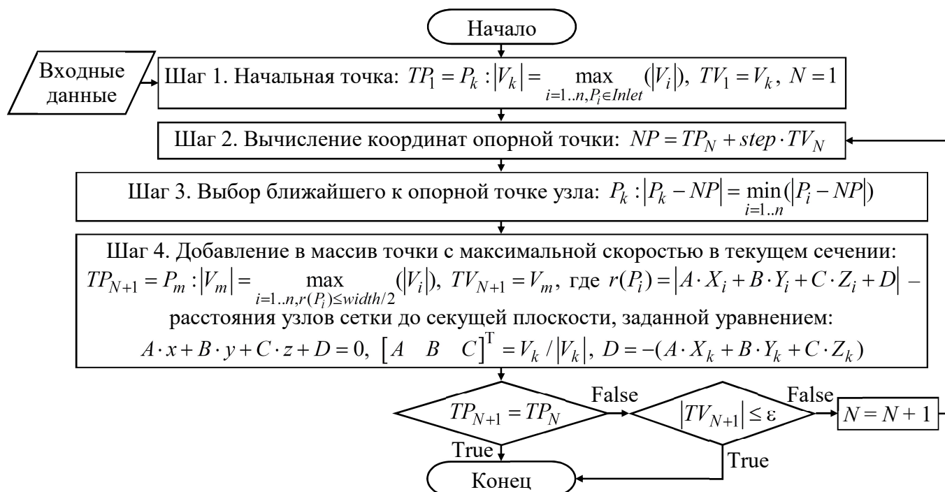
Рисунок 14 – Поясняющая схема к алгоритму построения ЛМС потока
