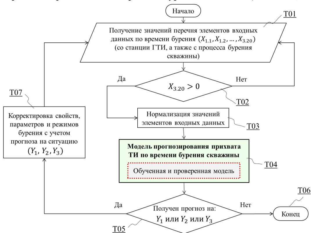
Рис. 4. Алгоритм обработки данных для прогнозирования прихвата ТИ по времени бурения скважины.
