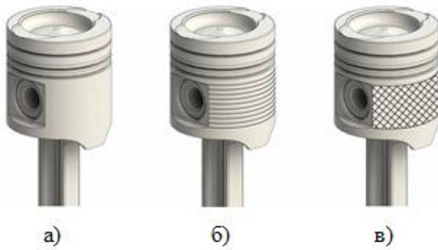
Рисунок 5. Виды регулярной микрогеометрии юбки поршня:
