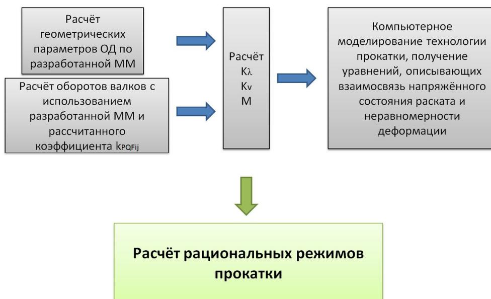
Рисунок 5 – Общая схема методики расчёта показателей напряжённого состояния раската в очаге деформации при прокатке труб на трёхвалковом НРС
