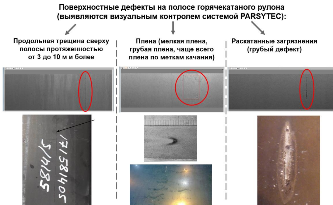
Рисунок 5 – Распространённые поверхностные сталеплавильные дефекты на металлопрокате ЛПК, связанные с неметаллическими включениями
