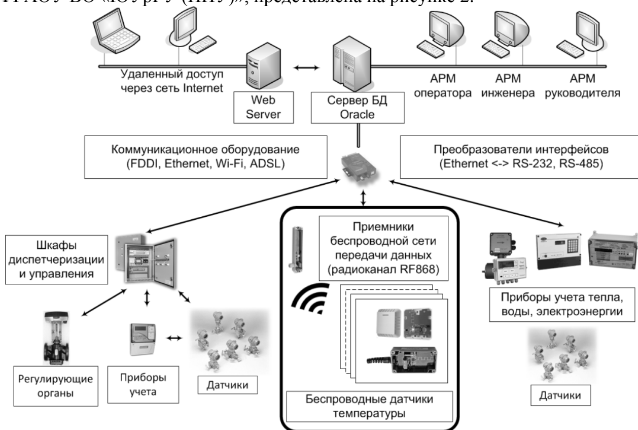
Рисунок 2 – Структурная схема автоматизированной системы оперативного управления теплоснабжением зданий на основе сенсорных сетей
