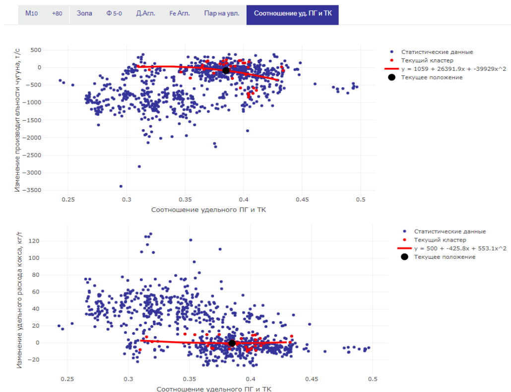
Рис. 16. Пример зависимость дутьевых параметров (соотношения удельного расхода природного газа и технологического кислорода) на производительность и удельный расход кокса для ДП9
