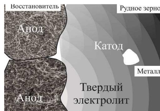
Рис. 8. Схема концентрационного гальванического элемента
