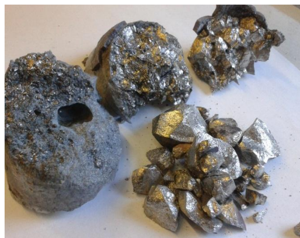
Рисунок 9 – Данные рентгенофазового анализа, где 1- \text{Al}_3\text{Zr} (66%), 2 - \text{Al}_2\text{Zr} (34%) и фото образца №7, полученного в индукционной печи
