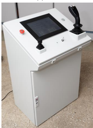
Рисунок 9 – Пульт управления манипулятором МР-48
