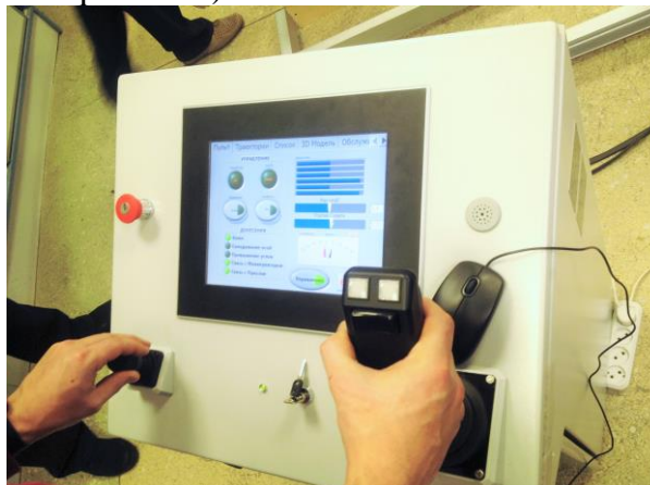
Рисунок 9 – Пульт управления манипулятором МР-48
