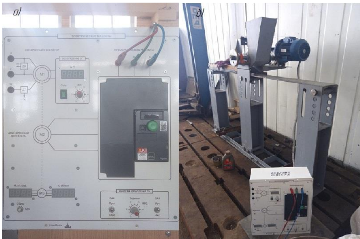
Рисунок 5.2.2. Частотный преобразователь INSTART, серии MCI-G3/7-4D а) общий вид; б) подключенном на стенде виде
