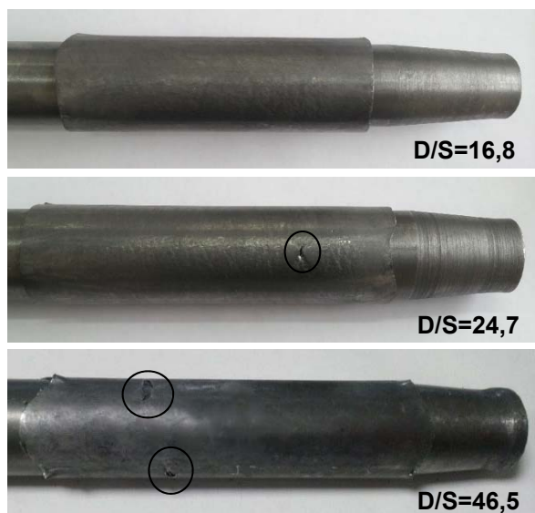
Рисунок 4 – Формирование поперечных разрывов в зависимости от овальности чистовых калибров и тонкостенности раскатываемых труб
