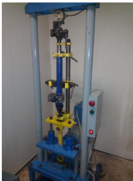
Рисунок 6 – Внешний вид стенда испытаний амортизаторов
