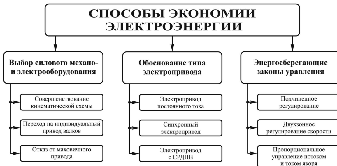
Рис. 2. Основные способы экономии электроэнергии в электроприводах пилигримовых станков
