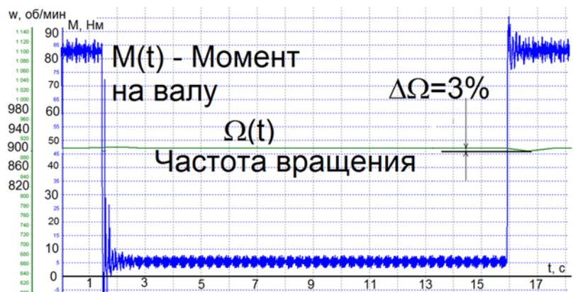
Рис. 5. Временные диаграммы наброса нагрузки при стабилизированной системе частотного управления СДПМ
