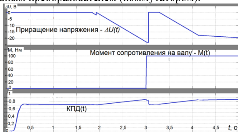
Рис. 13. Процесс автоматического поиска наибольшего значения КПД СДПМ
