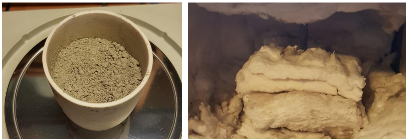
Рисунок 29 – Подготовка образца к эксперименту (слева – образец в тигле, справа – тигель в постели внутри микроволновой установки)
