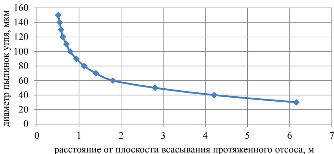
Рис. 7. Зависимость размеров всасываемых частиц угольной пыли от расстояния до плоскости всасывания протяженного отсоса
