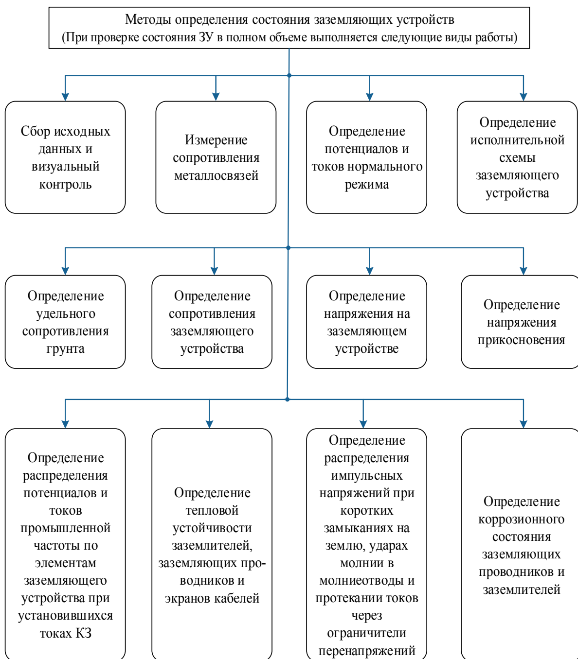
Рисунок 1 – Структурная схема проверки состояния ЗУ
