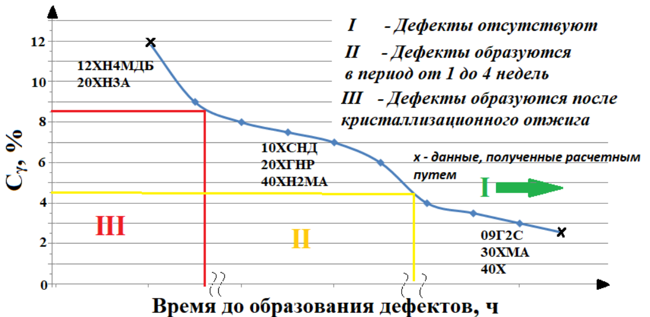
Рисунок 59 – Зависимость времени до образования дефектов в композитном никель-фосфорном покрытии от содержания остаточного аустенита в подложке
