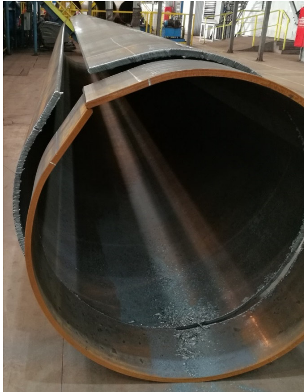
Рисунок 3.8 – Изменение диаметра кольца в результате отрезки от трубной заготовки
