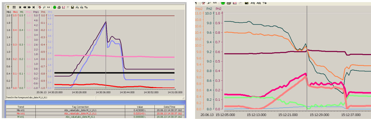
Рисунок 3.4 – Диаграммы измеряемых нагрузок: 1– тяговое усилия; 2– усилие прижатия.
