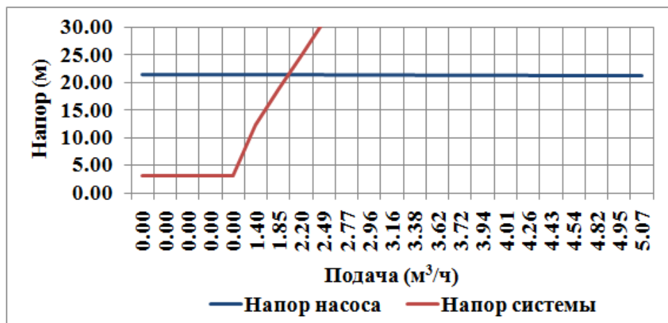
Рисунок 2.19 – Рабочая точка системы и номинальная подача
