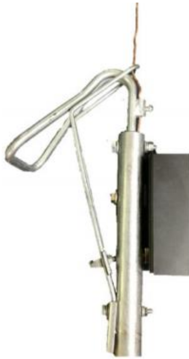
Рисунок 3.7 – Контролирующее устройство с автономным пультом, закрепленное на переносной заземляющей штанге контактной сети
