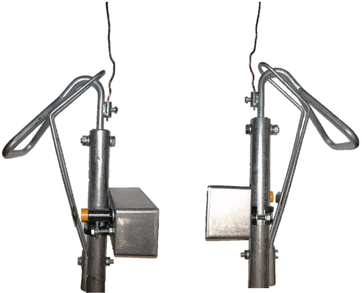
Рисунок 3.21 – Контролирующее устройство с датчиком приближения, закрепленное на переносной заземляющей штанге контактной сети
