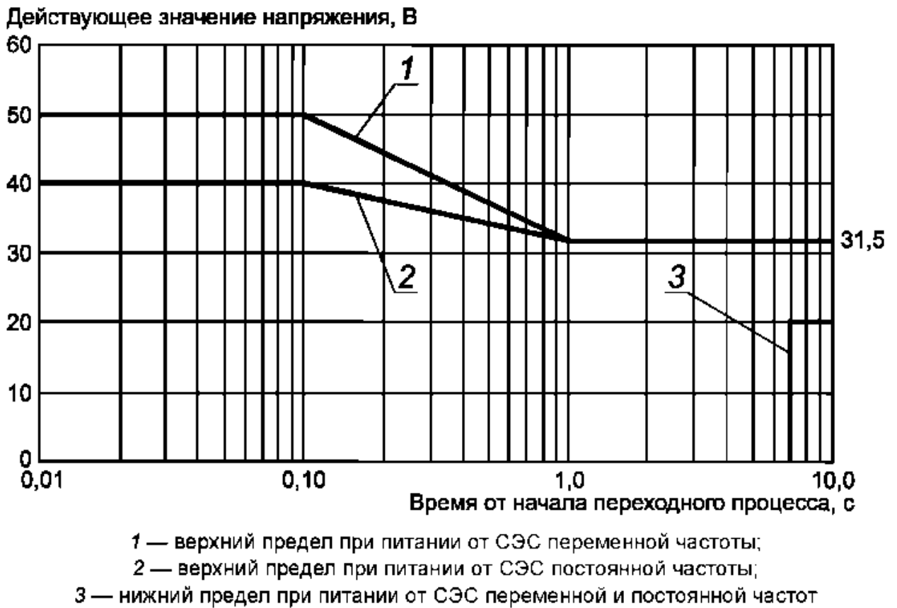
Рисунок 1.15 – Пределы приведенных значений ненормальных повышенных и пониженных напряжений вторичных систем постоянного тока 27 В
