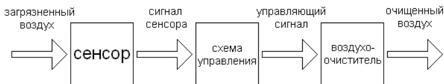
Рисунок 2.27 – Функциональная схема системы управления фотокаталитическим воздухоочистителем
