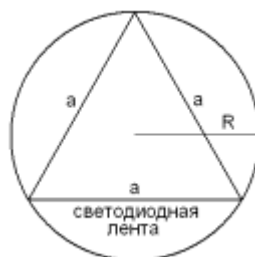
Рисунок 2.16 – Равнобедренный треугольник, вписанный в окружность: а – ширина светодиодной ленты; R – радиус окружности
