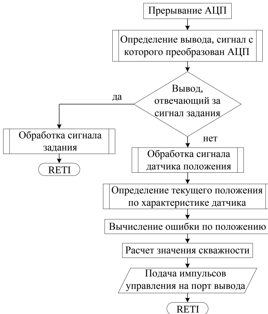
Рис. 6.6. Блок-схема подпрограммы вычисления значения скважности
