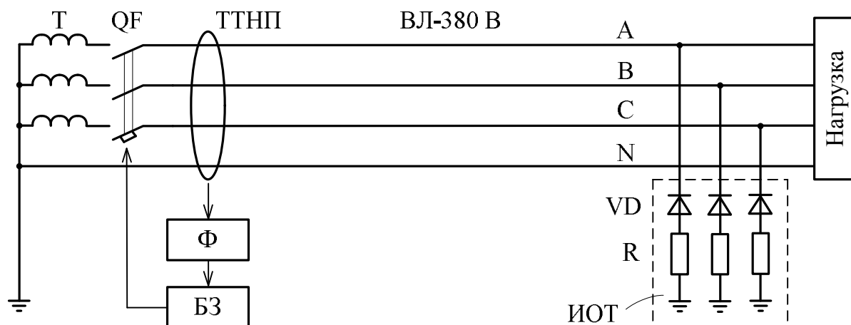
Рисунок 1.9 – Схема защиты, построенная с использованием наложенного тока
