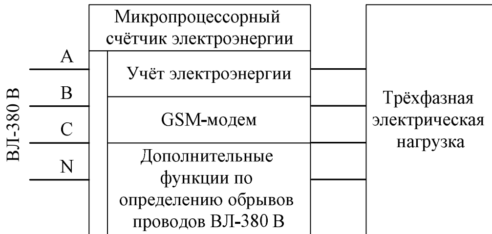
Рисунок 3.9 – Структурная схема микропроцессорного счётчика электрической энергии
