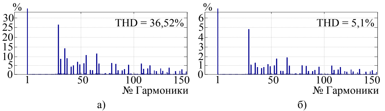
Рисунок 4.18 – Результаты математического моделирования для ШИМ с УВГ 2
