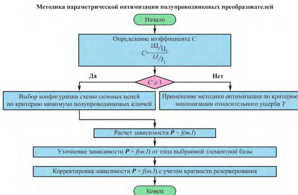
Рис. 2.45. Методика параметрической оптимизации полупроводниковых преобразователей
