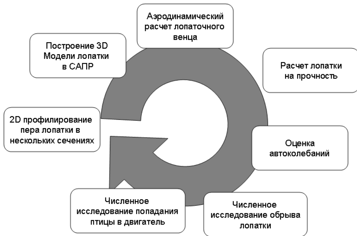
Рис. 5.4. Процесс проектирования вентилятора ГТД
