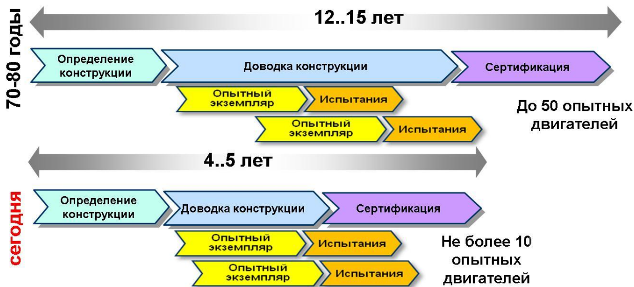
Рис. 5.3. Цикл проектирования авиационного газотурбинного двигателя.
