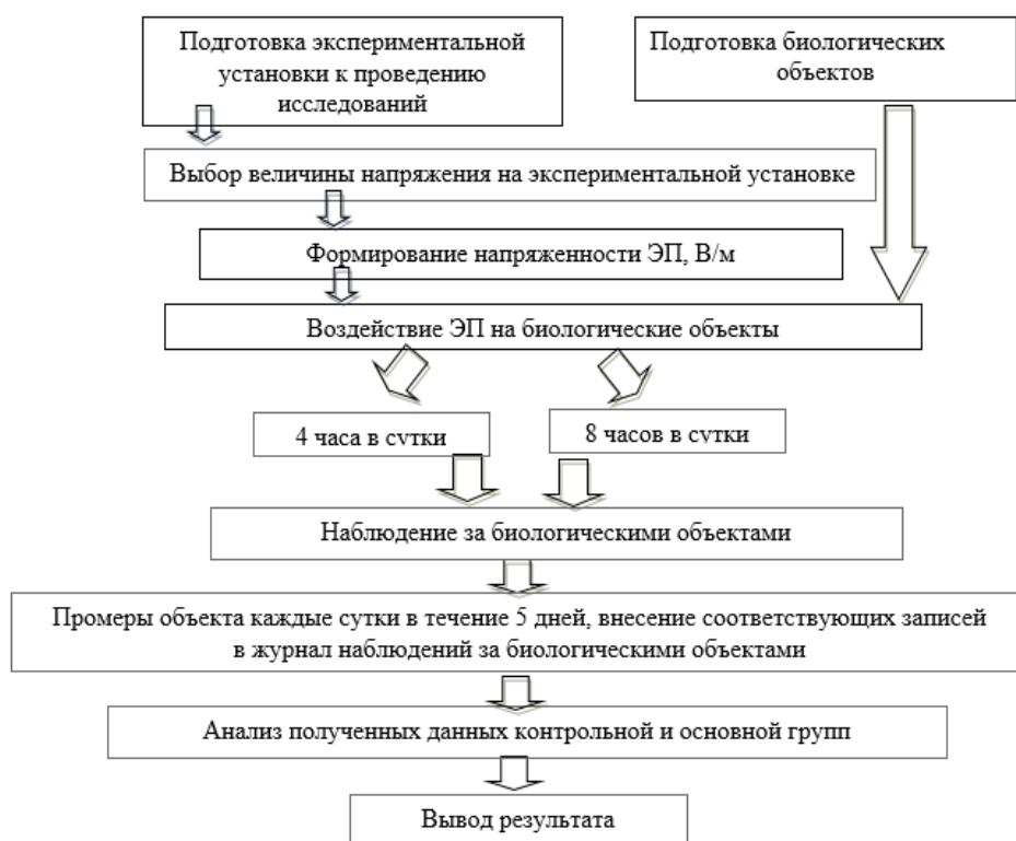
Рисунок 2.9 – Структурная схема проведения эксперимента по исследованию воздействия ЭП на биологические объекты» [46]
