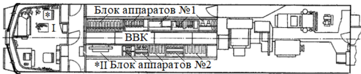
Рисунок 4.1 – Эскиз плана электровоза ВЛ11 с расположением точек измерения напряженности электрического и магнитного полей [60]
