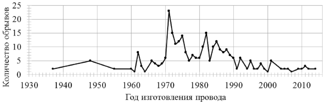
Рисунок 2.5 – Зависимость количества обрывов ВЛ 6–10 кВ от года изготовления провода
