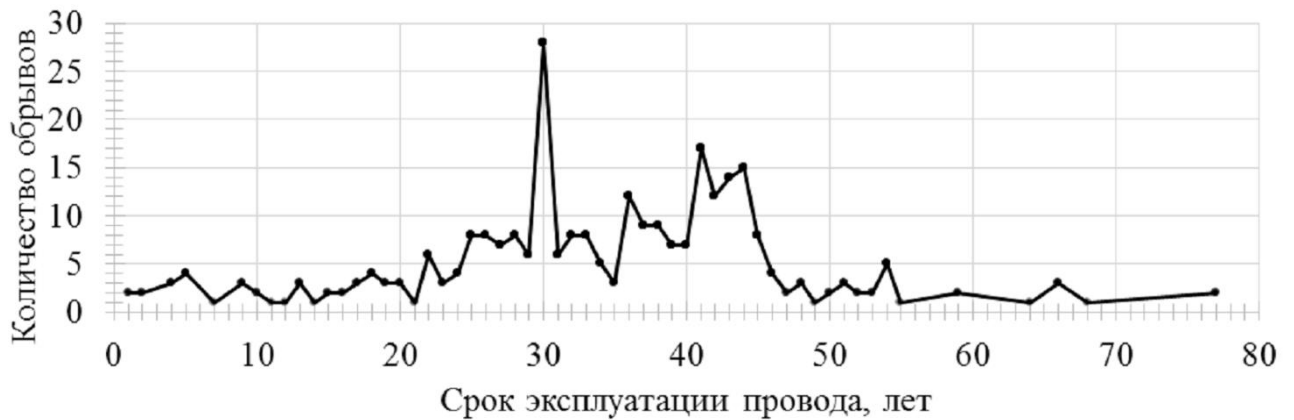
Рисунок 2.6 – Зависимость количества обрывов ВЛ 6–10 кВ от срока эксплуатации провода
