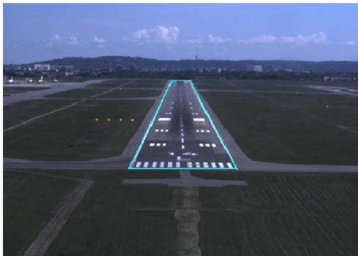
Рис. 3. Распознавание контуров полосы системой технического зрения самолета Airbus 350
