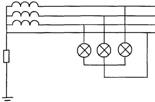
Рис. 4.8. Трехфазная схема включения газоразрядных ламп
