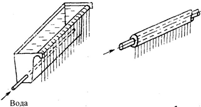
Рис. 7.15. Устройства для создания водяной пленочной завесы
