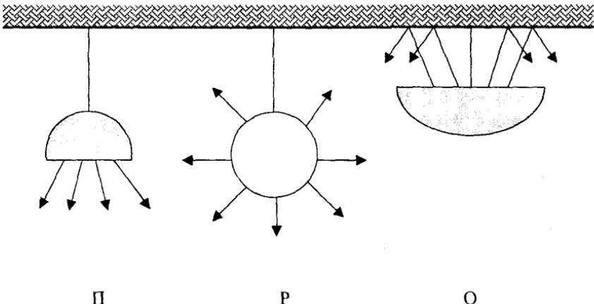
Рис. 4.11. Виды светильников в зависимости от доли светового потока, приходящейся на нижнюю полусферу
