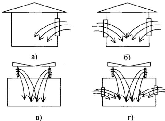
Рис.4.2. Виды естественного освещения в зависимости от конструктивного исполнения
