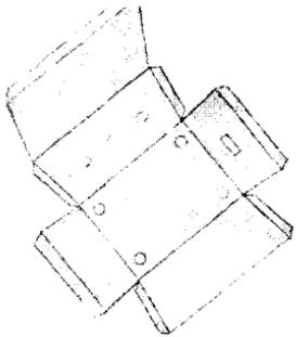
Рис. 7.9. Экран, выполненный в виде замкнутой камеры (развертка)
