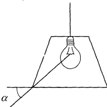
Рис. 4.12. Защитный угол светильника
