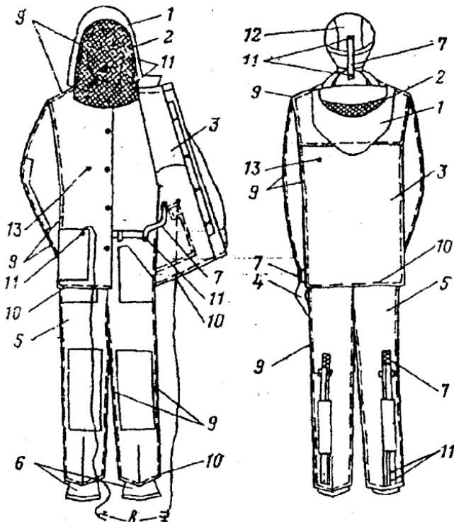
Рис. 7.6. Общий вид экранирующего комплекта для работ под напряжением (спереди и сзади): 1 – экранирующий капюшон; 2 – экран для лица; 3 – экранирующая куртка; 4 – экранирующие перчатки; 5 – экранирующие брюки; 6 – экранирующая обувь; 7 – контактные выводы и перемычки; 8 – проводники с зажимами; 9, 10 – соответственно основные и дополнительные каналы повышенной проводимости; 11 – контактные кнопки; 12 – экранирующий накатник; 13 – измерительная клемма для контроля состояния ткани
