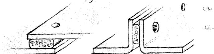
Рис.7.11. Экранирование неплотностей корпуса аппаратуры
