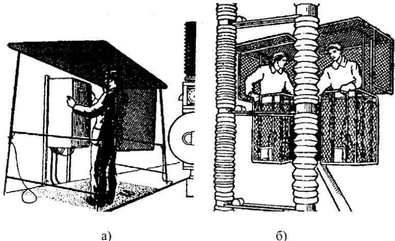
Рис. 7.5. Временные экранирующие устройства:
