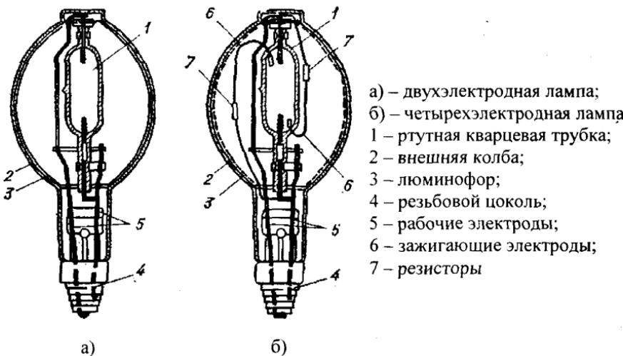
Рис. 4.10. Дуговая ртутная люминесцентная лампа типа ДРЛ
