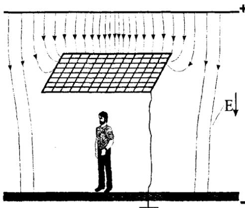
Рис. 7.3. Принцип действия экранирующего навеса
