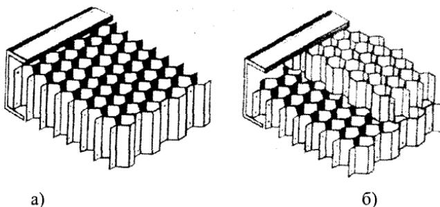
Рис. 7.10. Экраны в виде сотовых решеток с обычными (а), с пересекающимися (б) ячейками
