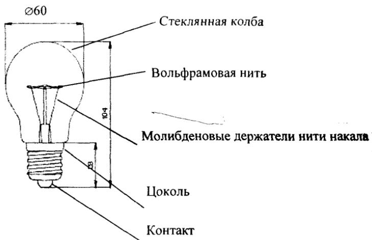
Рис. 4.7. Устройство лампы накаливания
