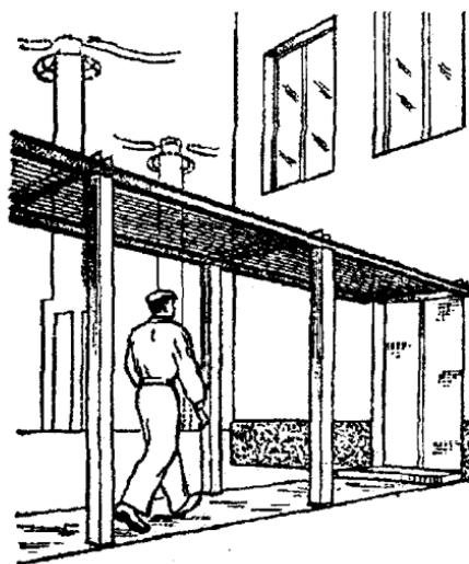
Рис. 7.4. Экранирующий навес над проходом в здание
