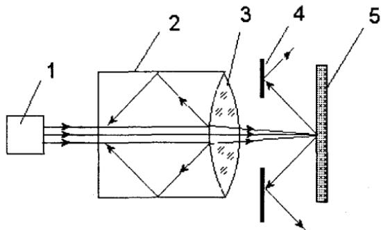
Рис. 7.12. Схема экранирования отраженного лазерного излучения блендами и диафрагмами:
