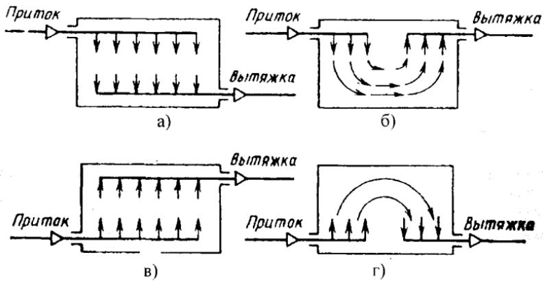
Рис. 3.11. Схемы организации воздухообмена при общеобменной вентиляции: а) сверху – вниз; б) сверху – вверх; в) снизу – вверх; г) снизу – вниз
