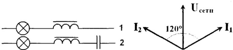
Рис. 4.9. Двухламповая схема включения газоразрядных ламп
