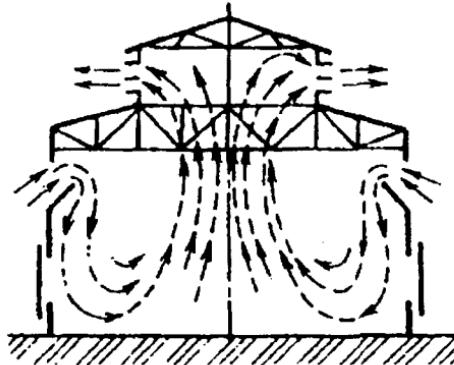
Рис. 3.9. Схема аэрации промышленного здания
