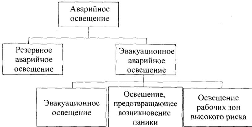
Рис. 4.3. Виды аварийного освещения
