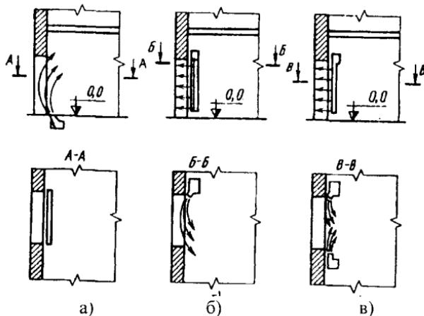
Рис. 3.7. Схемы воздушных завес: а) с нижней подачей воздуха; б) односторонние; в) двусторонние
