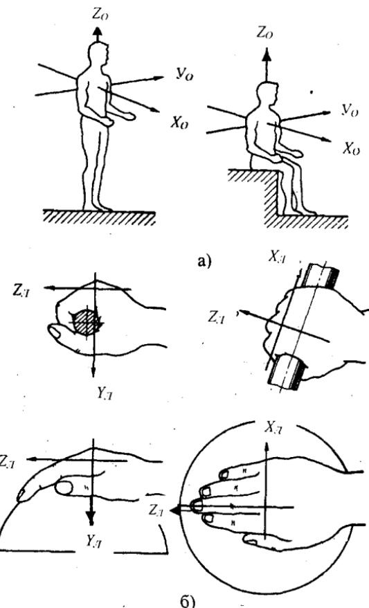
Рис. 5.2. Направление координатных осей при действии вибрации: а – общей (положение стоя и сидя); б – локальной (охват цилиндрических и сферических поверхностей)
