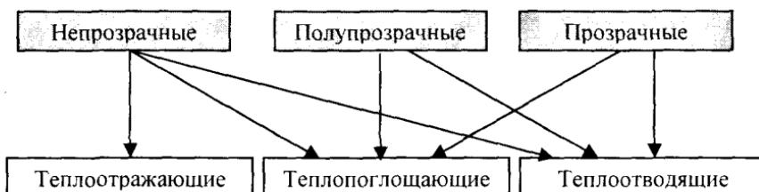
Рис. 7.14. Классификация теплозащитных экранов
