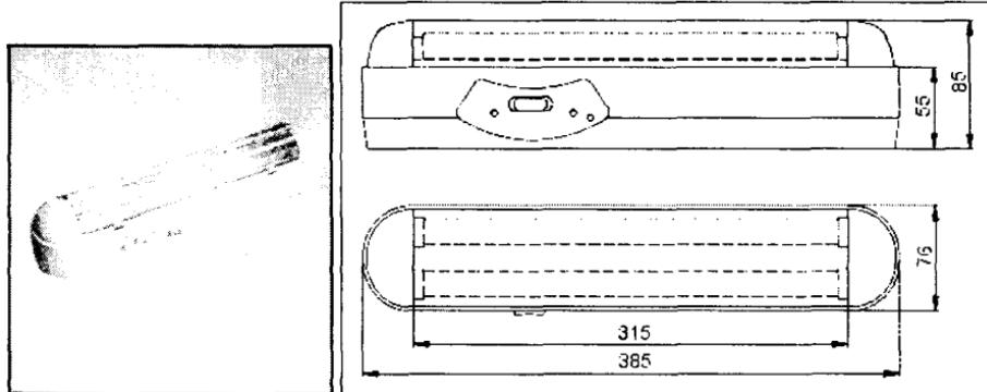
Рис.4.14. Светильник аварийного освещения
