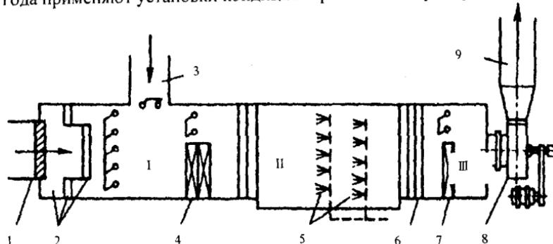
Рис. 3.13. Схема кондиционера: 1 – заборный воздуховод; 2 – фильтр; 3 – соединительный воздуховод; 4 – калориферы первой и второй ступеней подогрева; 5 – форсунки воздухоочистки; 6 – переходник-каплеуловитель; 7 – калориферы третьей ступени подогрева; 8 – вентилятор; 9 – отводной воздуховод
