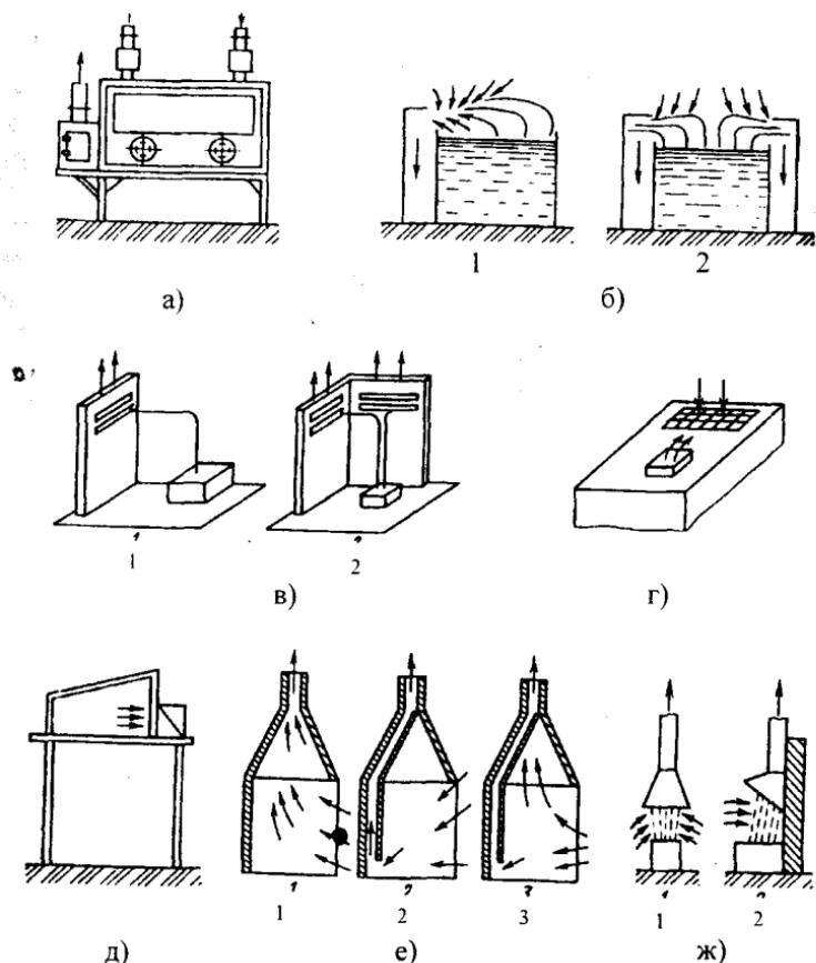
Рис. 3.10. Устройства местной вентиляции: а) укрытие (бокс); б) бортовые отсосы (1 – однобортовой; 2 – двубортовой); в) боковые отсосы (1 – односторонний; 2 – угловой); г) отсос от рабочих столов; д) отсос витражного типа; е) вытяжные шкафы (1 – с верхним отсосом; 2 – с нижним отсосом; 3 – с комбинированным отсосом); ж) вытяжные зонты (1 – прямой; 2 – наклонный)
