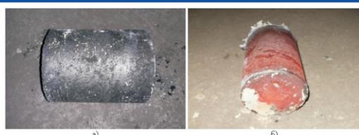
Рис. 1. Внешний вид заготовки, полученной на машине центробежного литья вертикального типа, а – вид сбоку, б – вид снизу
