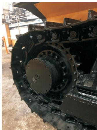
Рис. 1. Опытный образец бесступенчатого дифференциального механизма поворота со следящей системой управления
