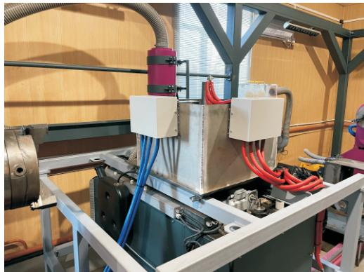
Рис. 2. Установка для нанесения твердохромовых покрытий на внутренние поверхности компонентов ГП с ГСН
