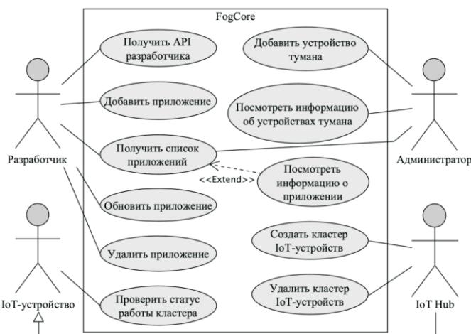
Рис.2. Диаграмма вариантов использования туманной вычислительной системы FogCore
