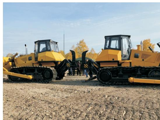
Рис. 4. Проведение приемочных (полевых) испытаний опытных образцов бесступенчатого дифференциального механизма поворота со следящей системой управления
