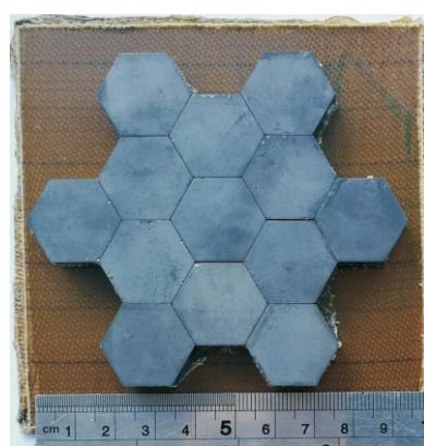
Рис. 3. Образец керамокомпозитной структуры для проверочных испытаний
