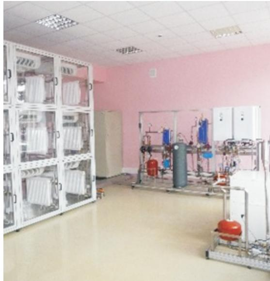
Рис. 1. Автоматизированная имитационная установка для полунатурного моделирования теплогидравлических режимов в инженерных системах объектов ЖКХ и режимов работы отопительного оборудования совместно с модулем исследований технических характеристик полевого сенсорного оборудования
