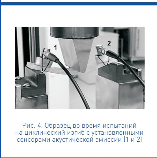
Рис. 4. Образец во время испытаний на циклический изгиб с установленными сенсорами акустической эмиссии (1 и 2)
