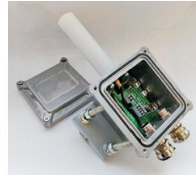
Рис. 2. Экспериментальные образцы автономных интеллектуальных сенсоров давления и температуры
