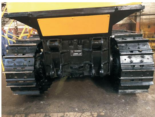
Рис. 3. Опытный образец бесступенчатого дифференциального механизма поворота со следящей системой управления установленный в машину для проведения испытаний
