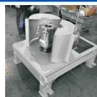
Рис. 2. Внешний вид изготовленной машины центробежного литья вертикального типа
