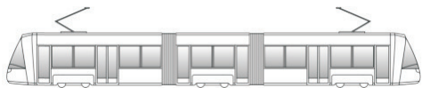
Рис. 1. Базовый вариант (6-осный 3-секционный вагон с моторными поворотными и безмоторной неповоротной тележками). Модификация "Б" (6-осный 3-секционный вагон с моторными поворотными и неповоротной тележками)
