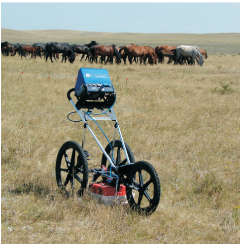
Рис. 2. Георадарная система SIR-3000 в комплектации для исследований на археологических памятниках
