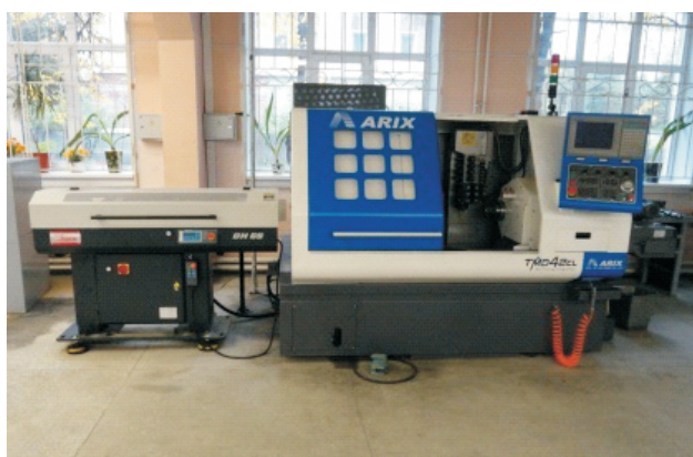
Рис. 4. Токарно-фрезерный обрабатывающий центр с податчиком прутка
