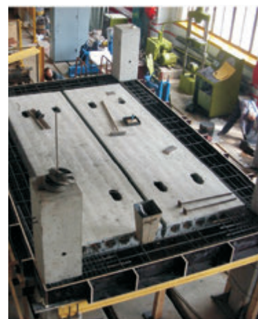
Рис. 1. Высокоэффективные энерго- и ресурсосберегающие строительные материалы. Безбалочные сборно-монолитные перекрытия многоэтажных зданий с предварительно напряженными железобетонными плитами
