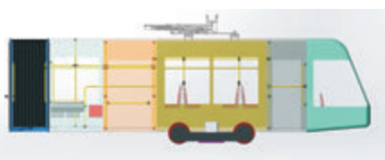
Рис. 4. Головная секция вагона, собранная из базовых модулей
