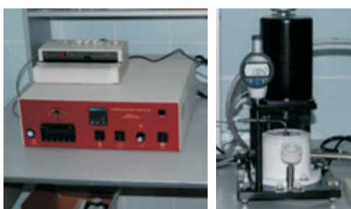
Рис. 6. Аппарат для измерения вязкости жидкостей при высоких скоростях сдвига и температуре 150 °С
