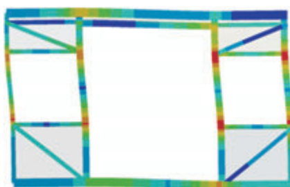
Рис. 6. Напряженное состояние каркаса боковины с усиливающими раскосами в режиме подъема за лобовую балку
