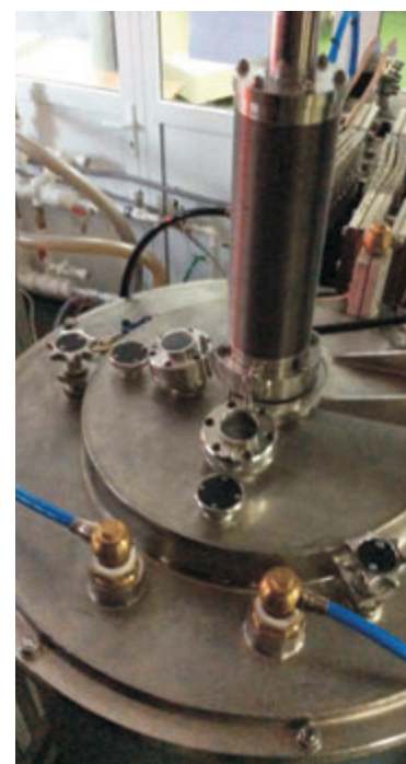
Рис. 1. Установка для выращивания монокристаллов (вид сверху)
