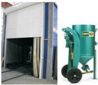
Рис. 6. Дробеструйная камера с дробеструйным аппаратом
