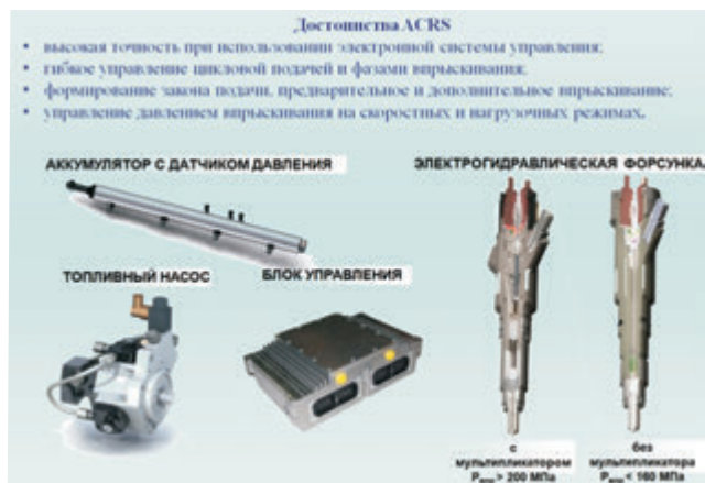
Рис. 4. Импортозамещающие компоненты аккумулирующей системы впрыскивания ACRS (ALTAI COMMON RAIL SYSTEM)
