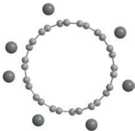
Рис. 1. Модель комплекса УНТ(7,7) + 7 атомов лития (вид с торца)
