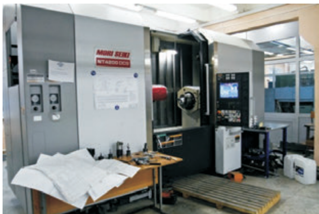
Рис. 3. Четырехосевой токарно-фрезерный обрабатывающий центр
