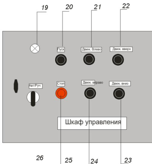
Рис.П1.2 Внешний вид шкафа управления
