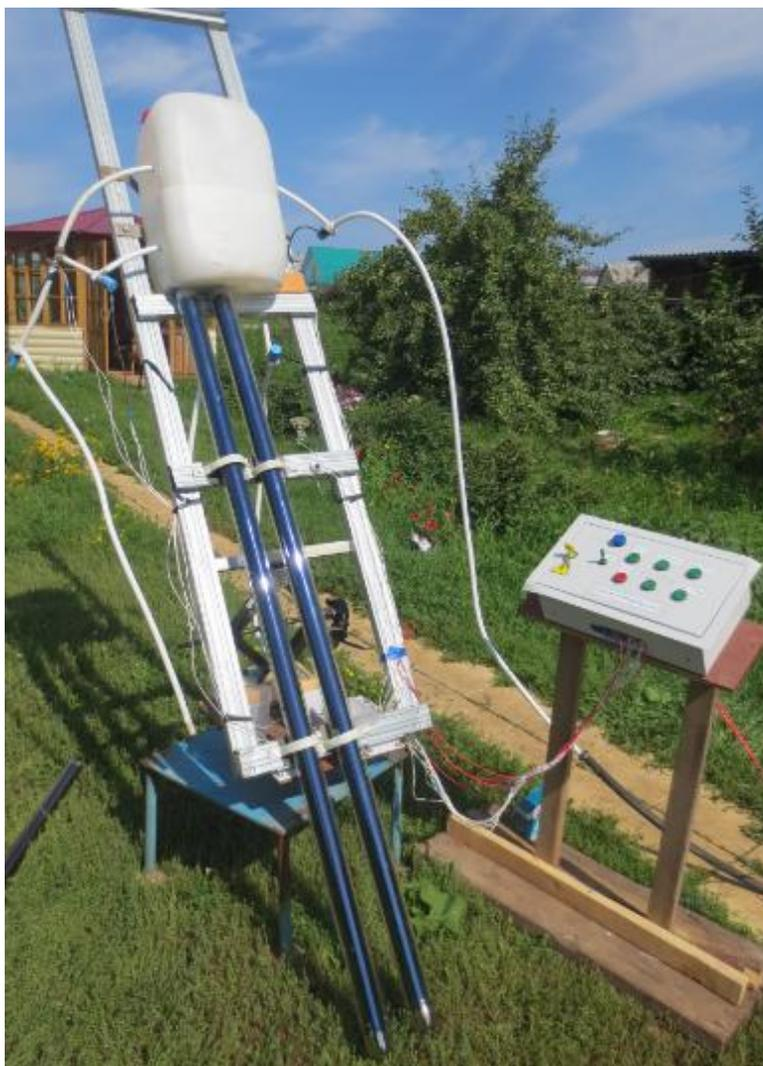
Рис. 3.1. Солнечная опреснительная установка
