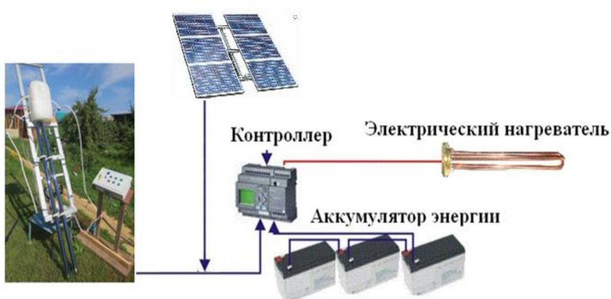
Рис. 5.6. Схема использования солнечных батарей в солнечной опреснительной установке
