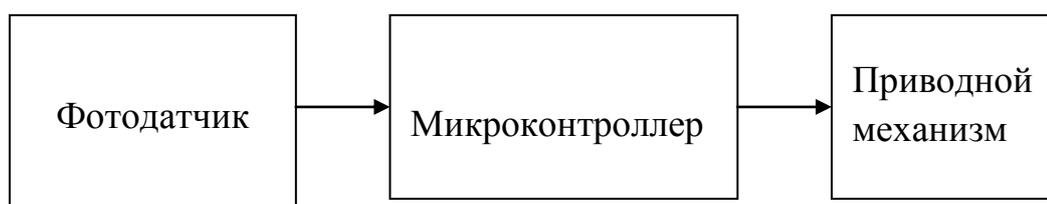
Рис. 4.5. Структурная схема устройства слежения за солнцем
