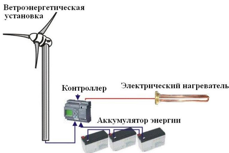
Рис. 1.5. Схема подключения ветроэнергетической установки к электрическому нагревателю
