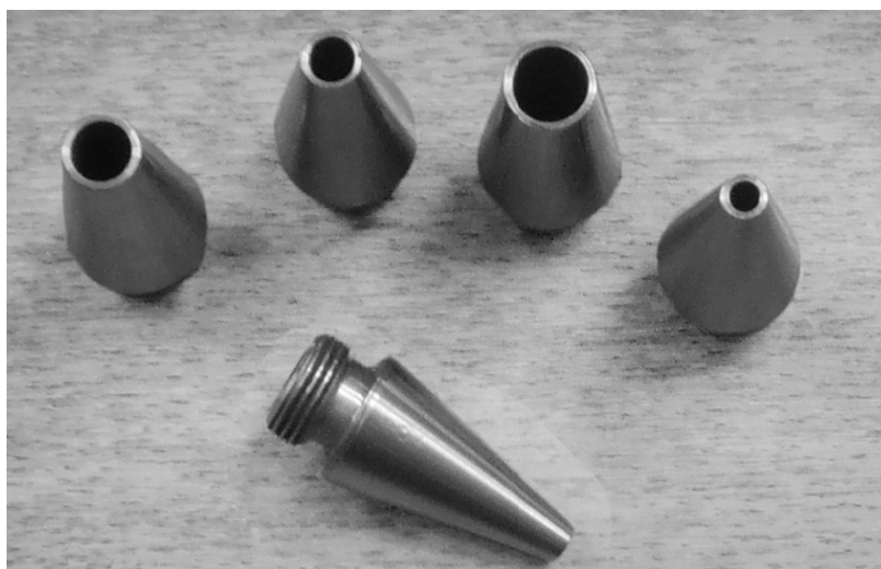
Рис. 2.9. Сопла второй ступени
