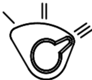
Рис. 2.5. Схематичный вид переключателя насоса WCP 25
