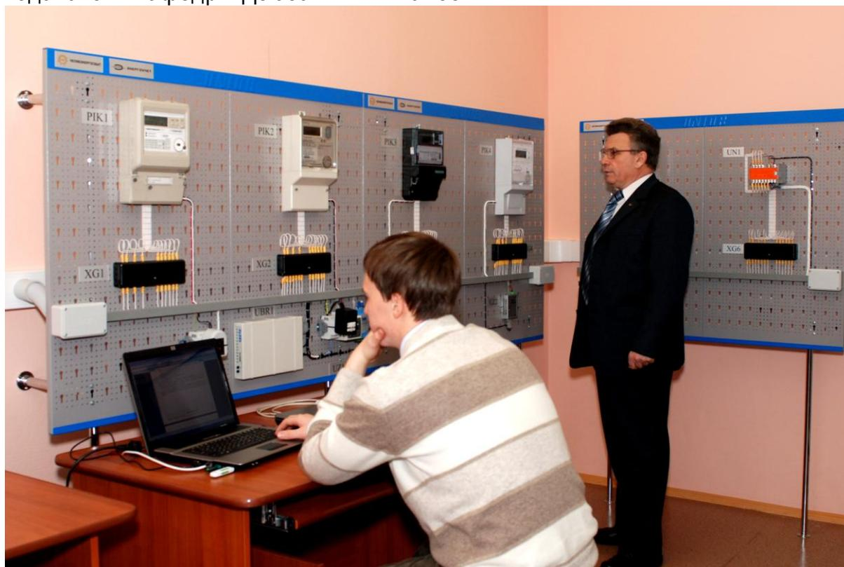
Лабораторный стенд по исследованию работы АИИСКУЭ, в том числе и счётчиков электрической энергии, ауд. 155
